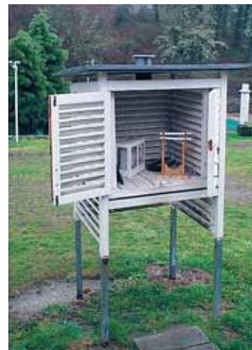
Figura 5.1. Garita meteorolóxica cun termohigrógrafo e termómetros de máxima e mínima
