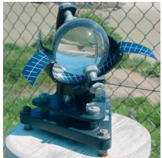
Figura 5.3. Heliómetro tipo Campbell-Stokes
