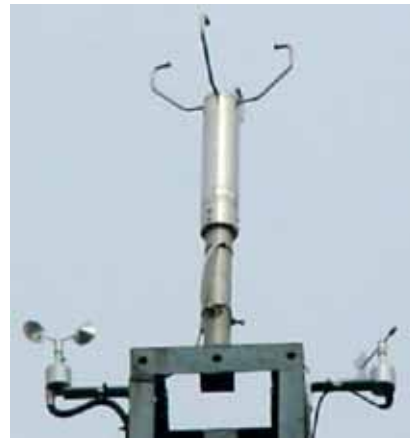
Figura 5.2. Anemómetro e catavento convencionais e un sensor que mide a velocidade e dirección do vento mediante ultrasóns (no centro)
